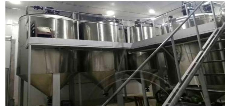
La configuración del equipo de filtración en frío a baja temperatura es para configurar el tamaño y cantidad del tanque de acuerdo a los diferentes requerimientos de materias primas.
