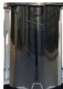
Basado en la salpicadura de aceite en el proceso de prensado de aceite, cada prensa de aceite hidráulico de nuestra fábrica está equipada con una cubierta de acero inoxidable fuera de cada barril de prensado. Resuelva el problema de las salpicaduras de aceite, ahorre aceite para los clientes, reduzca el desperdicio innecesario.
