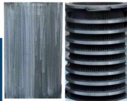
En general, el material con alto contenido de aceite puede usar un barril de prensado de bandas, y el material con bajo contenido de aceite puede usar un barril de prensado de perforación.
