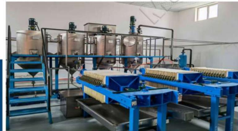
Cuando se usa prensado en caliente para extraer aceite, es necesario calentar la materia prima a una cierta temperatura (generalmente 100-130 ° C) para destruir la película de aceite en la materia prima y lograr el efecto de la extracción de aceite de una sola vez. Además, el método de prensado en caliente puede estimular el aroma de las materias primas y también es el método preferido para la mayoría de los aceites aromáticos.
